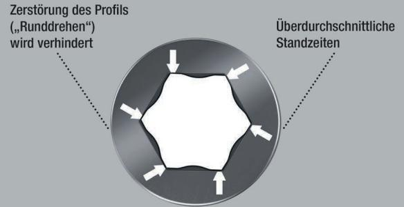
Hex-Plus bietet größere Anlageflächen im Schraubenkopf. Die Kerbwirkung wird dadurch auf ein Minimum reduziert, die Zerstörung des Schraubenkopfes nahezu eliminiert.
