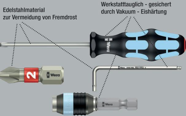
Hochwertiger Kraftform Plus Schraubendreher aus Edelstahl. Die Edelstahlwerkzeuge von Wera sind vakuumeisgehärtet und verfügen damit über die für Verschraubungen benötigten Härten und Festigkeitswerte. Der industrielle Einsatz ist ohne Einschränkungen möglich.
