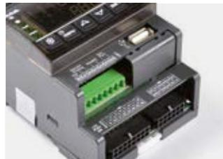
**Modbus-Schnittstelle RS485, eingebaut**
