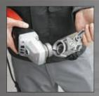
Passt sich jeder Position an Die Schnellkupplung ermöglicht variable Positionen der Werkzeugvorsätze. So kann zum Beispiel die Position des Handgriffs je nach Bedarf eingestellt
