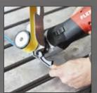
Einfacher geht's nicht Einfach den Spannhebel lö-sen und der Werkzeugvorsatz kann bequem und schnell gewechselt werden.
