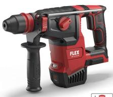
Akku-Spannung 18 V · Akku-Kapazität 2,5 / 5.0 Ah Werkzeugaufnahme SDS-plus Leerlaufdrehzahl 0.980 U/min Leerlaufschlagzahl 0-4350 /min · Max. Einzelschlagenergie 2,6 J · Max. Bohr-D. in Stahl 13 mm • Max. Bohr.-D- in Beton 26 mm · Max Bohr-D. in Holz 30mm Bohrfutter-Spannweite 1,5 - 13 mm · Gewicht ohne Akku 3,18 kg
